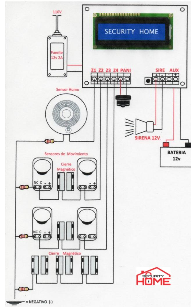
**NOTA:** las resistencias FINDE LÍNEA de 2,2 KΩ se pueden cerrar con cualquier negativo, puede ser con el negativo del último sensor en caso de tener un sensor infrarrojo o de humo.
